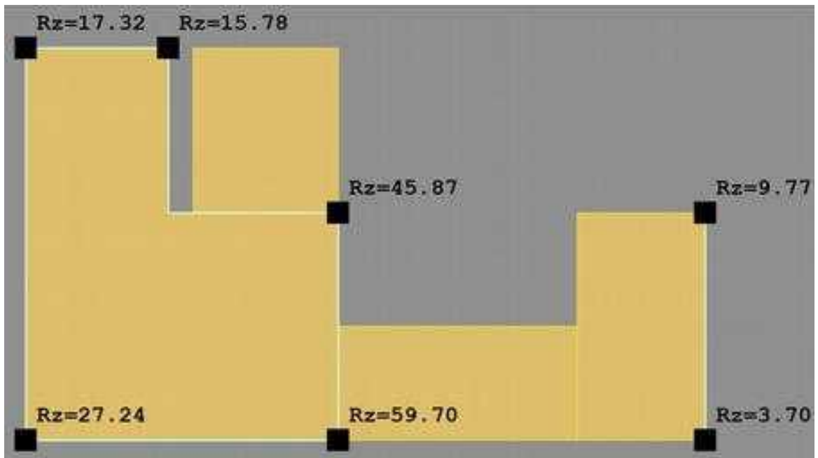
ILUSTRACIJA 10: REAKCIJE U STUBOVIMA USLJED RADNOG OPTEREĆENJA
