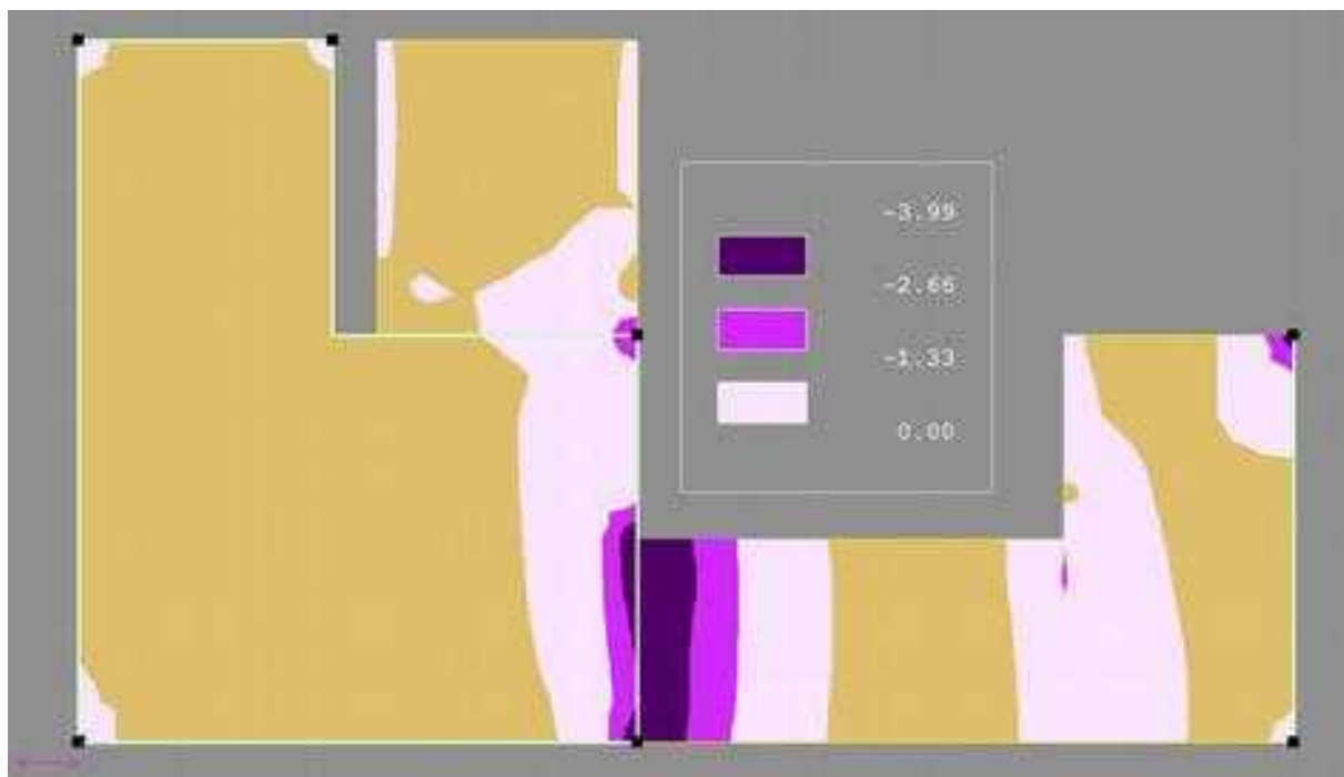
ILUSTRACIJA 8: GORNJA ARMATURA (X-PRAVAC)
