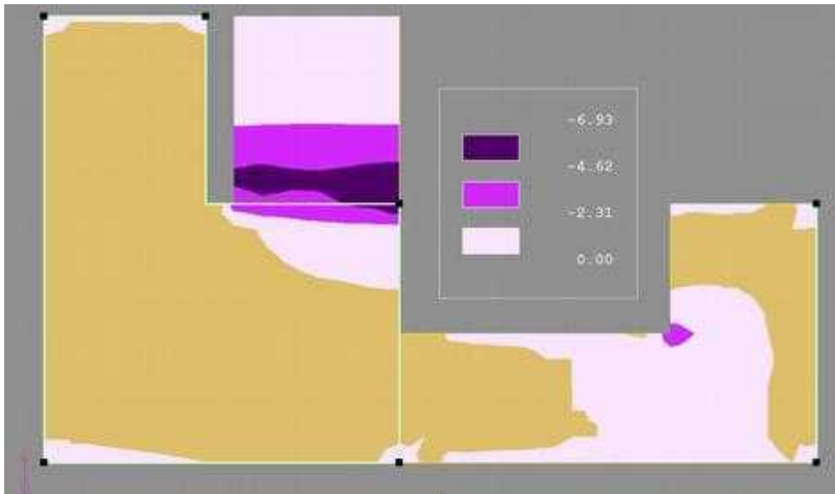
ILUSTRACIJA 7: GORNJA ARMATURA (Y-PRAVAC)
